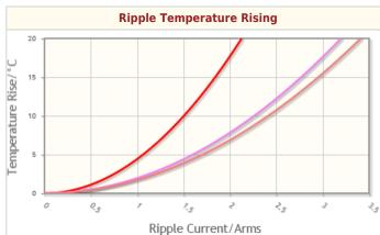
C2012X7R1H225K125AC(100kHz) C2012X7R1H225K125AC(500kHz) C2012X7R1H225K125AC(1MHz)
